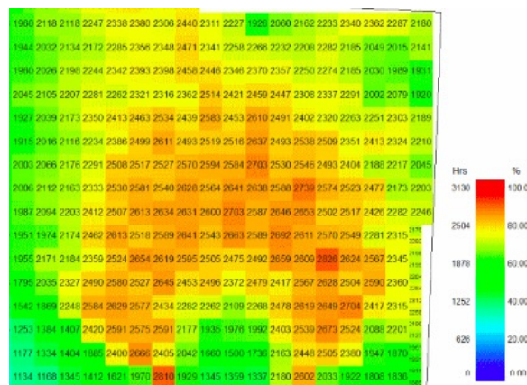
Figura 13. Ejemplo de resultados de simulación de luz natural.
